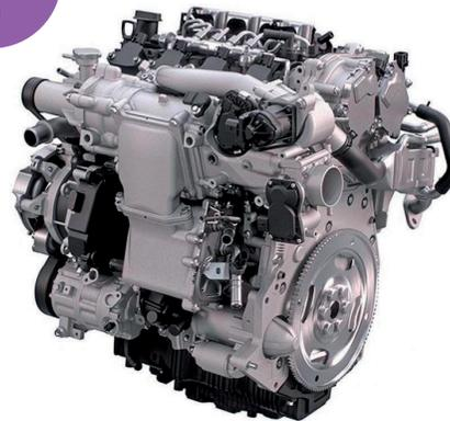
El motor de los automóviles es de **combustión interna**, ya que el combustible es quemado dentro de él.
